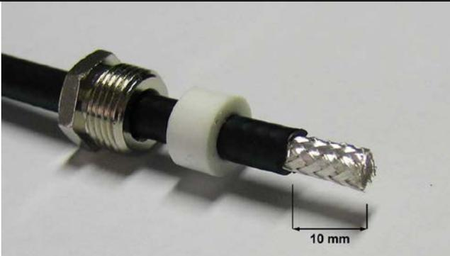
Inserire il dado di serraggio e la guarnizione in gomma, rimuovere la protezione esterna per un lunghezza di 10 mm
