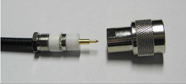
Inserire la rondella grande in teflon, il corpo connettore e stringere la ghiera di serraggio, utilizzare la chiave da 11 mm per la ghiera e da 13 mm per il corpo connettore
