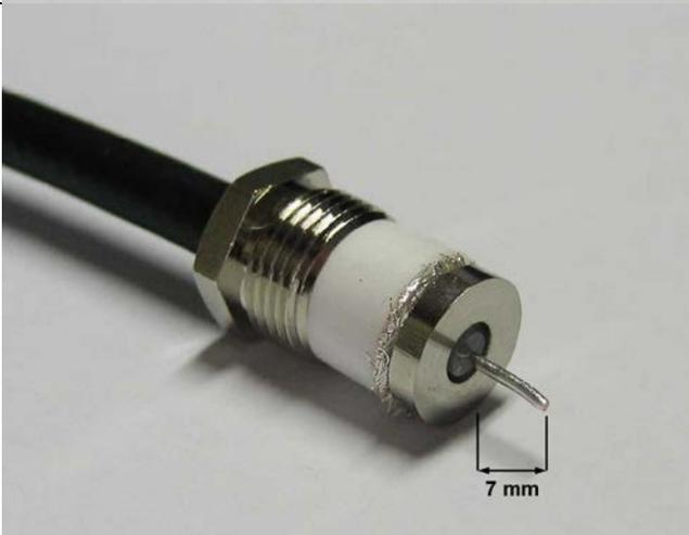
Ritagliare l'eccesso della calza e rimuovere l'isolante tagliandolo a filo della ghiera metallica, regolare la lunghezza del conduttore interno a 7 mm
